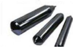
Figure 6 : lingots de silicium monocristallin (source : www.photovoltaïque.info/fr )
